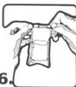
6. Para finalizar, dobre as pontas que sobram da fita de arame.
